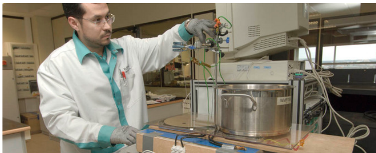
Ensayo de eficiencia energética de una encimera de inducción en el Centro de Competencia de Inducción del BSH en la factoría de Montañana (Zaragoza). BSH ELECTRODOMÉSTICOS ESPAÑA
